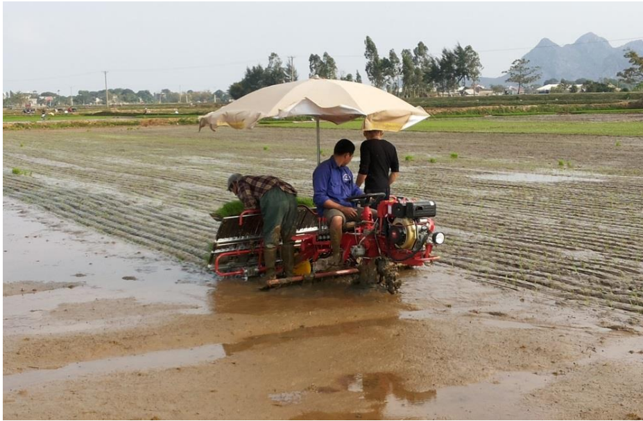
Hình 2.2. Máy cấy lúa HAMCO 2Z-8238BG-E-D
